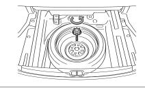
Loosen and remove the bolt.
